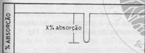
B. A amostra absorve energia somente na linha de ressonância
